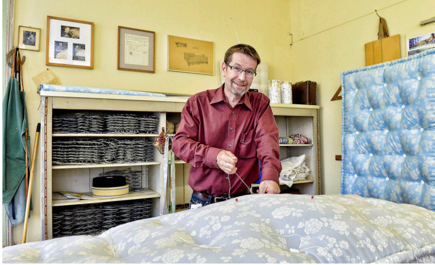
Pflegt ein selten gewordenes Handwerk: Matratzenmacher Heinz Roth in seiner Werkstatt. Hier beim Zusammenheften einer Rosshaarmatratze.
